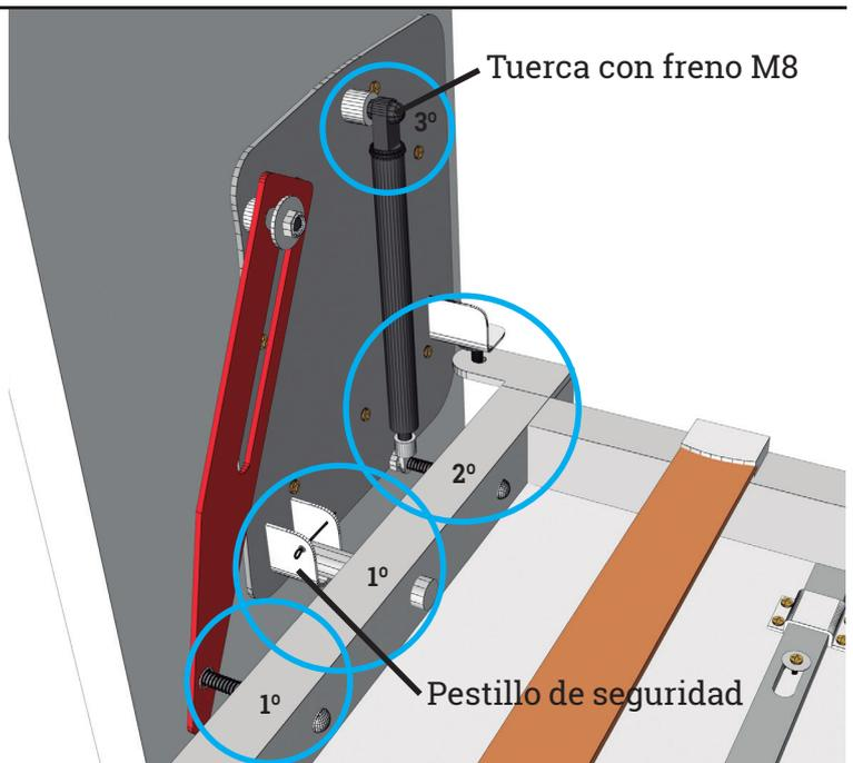
**NOTA:** Trabajar por detrás del mueble en ambos lados a la vez, apoyar los cilindros del somier sobre los asientos de las placas. Encajar las anillas de seguridad apretar y ecajar los bástagos y colocar los pistones dejando holgura para facilitar el cierre.
