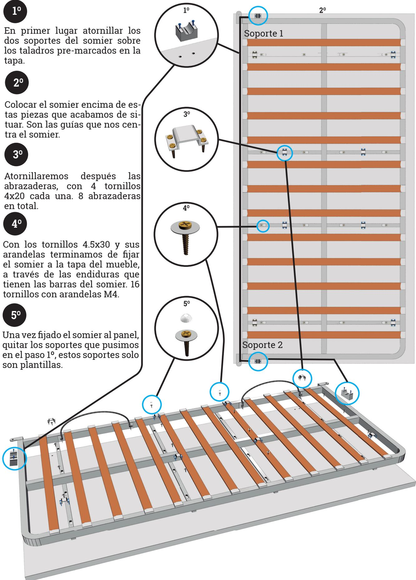
**NOTA:** Atornillar los dos soportes, Colocar encima de estas piezas el somier, después atornillaremos las 8 abrazaderas con 4 tornillos y se termina de atornillar con arandelas en los puntos.
