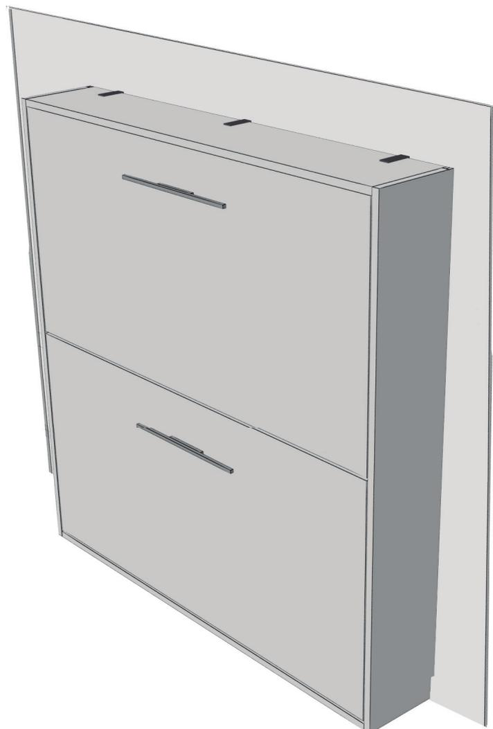
**NOTA:** Medir la altura del soporte al mueble, marcar los taladros guardando la misma distancia entre los soportes, taladrar, colocar los tacos fischer y tornillar a la pared, colocar el mueble a las escuadras sin forzar y atornillar.
