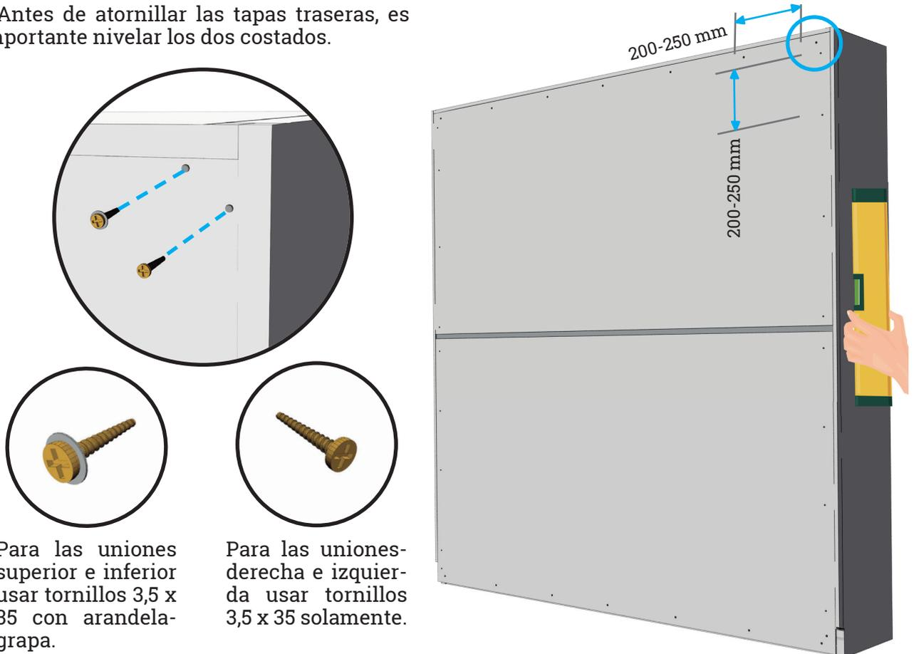
**NOTA:** Montar los tableros traseros con el perfil H y encajarlo en la parte superior e inferior de la estructura, nivelar a los costados y atornillar la trasera con los tornillos indicados.
