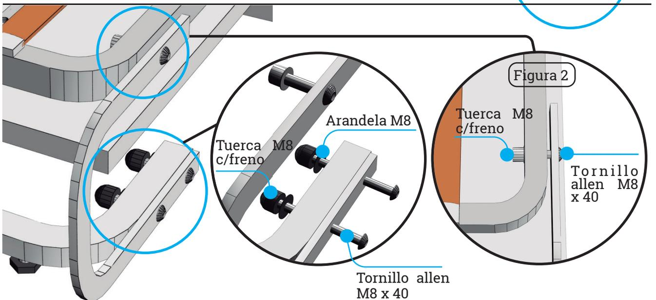
**NOTA :** Se Atornillan las dos patas a ambos lados del bastidor y posteriormente se atornillar lo dos extremos de las patas al somier.
