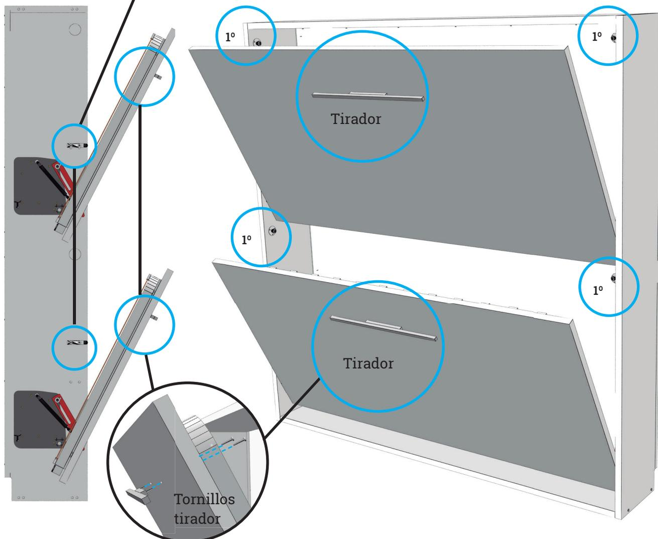
**NOTA :** Se atornillan los tiradores a la altura deseada, después a ambos lados del costado interior se atornillan las piezas / tope de regulación del cierre y por último se atornillan los 2 pistones de ajuste de cierre.
