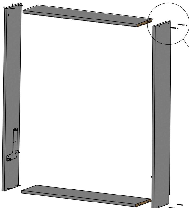
3º Encajar de manera segura los costados, con el piso y la capota enfrenar las espigas con los taladros coincidentes y atornillar los tornillos de rosca-golosa de 7x70.
