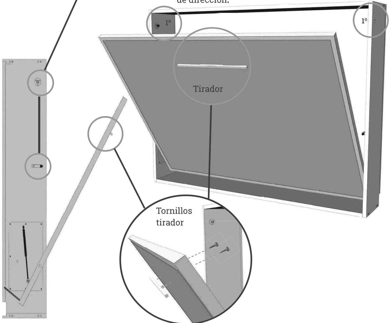
**NOTA :** Se atornilla el tirador a la altura deseada, después a ambos lados del costado interior se atornillan las piezas / tope de regulación del cierre y por último se atornillan los 2 pistones de ajuste de cierre.
