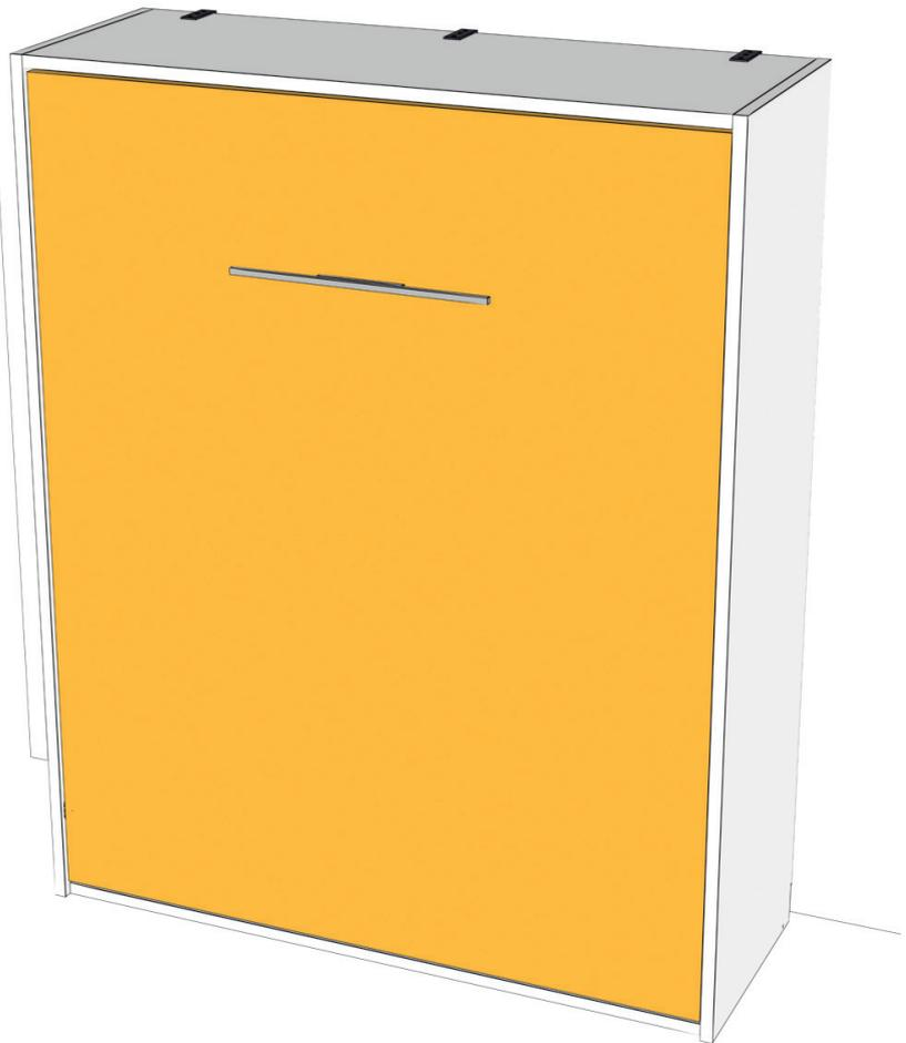
**NOTA :** Medir la altura del soporte al mueble, marcar los taladros guardando la distancia X1, X2 y X3 de la tapa, taladrar, colocar los tacos fischer y tornillar a la pared, colocar el mueble a las escuadras sin forzar y atornillar los 9 tornillos superiores (3 por cada escuadra).
